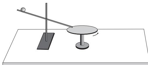
Шарик скатывается с желоба на горизонтальный диск. Если диск неподвижен относительно земли, то шарик катится по прямой. Если диск вращается и наблюдатель неподвижно связан с диском, то шарик катится по спирали.
